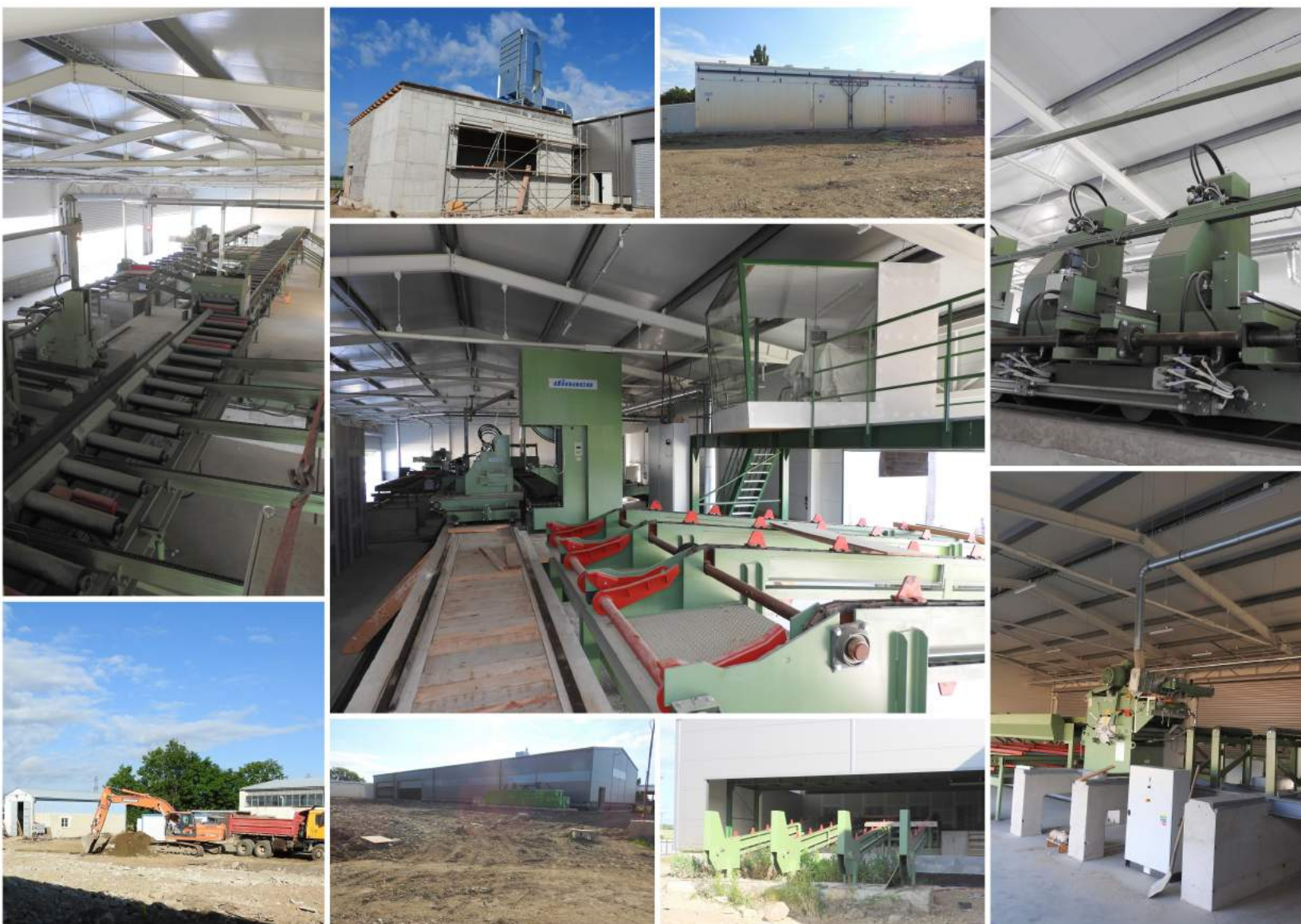
Budova pily, včetně již instalované technologie katrové pily. Budovy sušáren řeziva a kotelna.
